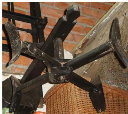
*Instrumento usado para la elaboración de las madejas*
