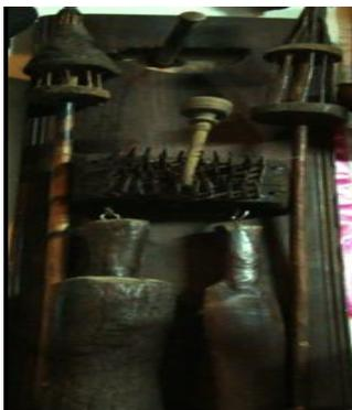
*Instrumento usados para cardar el lino*
